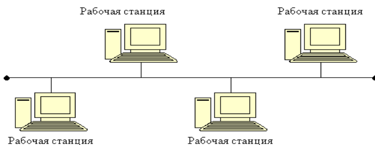
Рисунок 13. Сеть с шинной топологией
